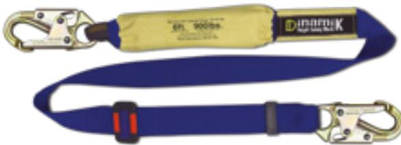
Eslinga regulable con absorbedor; fabricada en reata ignífuga Nomex - Kevlar capaz de soportar una carga de tracción mínima de 7,000 lbf. Hebilla de ajuste aislada (recubrimiento dieléctrico mínimo de 9 Kv) y ganchos en acero forjado con una resistencia a la tracción mínima de 5,000 lbf.
