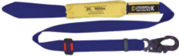
Eslinga regulable con absorbedor; fabricada en reata ignífuga Nomex - Kevlar capaz de soportar una carga de tracción mínima de 7,000 lbf. Hebilla de ajuste y ganchos en acero forjado con una resistencia a la tracción mínima de 5,000 lbf, poseen un recubrimiento aislado con una capacidad dieléctrica mínima de 9 Kv.
