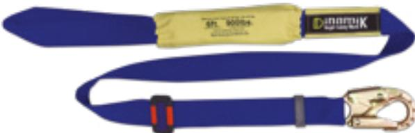
Eslinga regulable con absorbedor; fabricada en reata ignífuga Nomex - Kevlar capaz de soportar una carga de tracción mínima de 7,000 lbf. Hebilla de ajuste aislada (recubrimiento dieléctrico mínimo de 9 Kv), gancho en acero forjado con una resistencia a la tracción mínima de 5,000 lbf.
